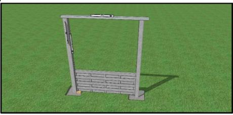
**Étape n°7 :** Procéder de la même façon pour les autres poteaux. Si vous terminez par une travée plus courte, utiliser un disque à matériaux pour couper les plaques.
