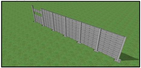
**Étape n°9:** Poser les plaques supérieures avec un appareil de levage équipé d'une pince.
