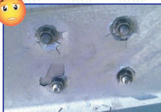
Photos 6 et 7 : Défauts de réactivité (fortes épaisseurs de zinc)
