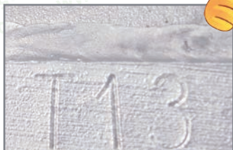
Photos 56 et 57 : La frappe à froid
