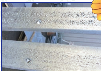
Photos 8 et 9 : Défauts dus au laminage
