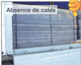
Photos 62 et 63 : Mauvais colisages
