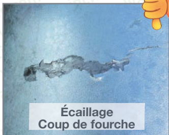
Photos 64 et 65 : Les conséquences d'un mauvais colisage
