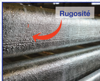
Photos 1 et 2 : Types d'aspects de surface dus à la réactivité des aciers
