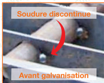
Photos 48 et 49 : Les défauts de soudures discontinues
