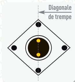
Figure 30 : L'accrochage d'une pièce
