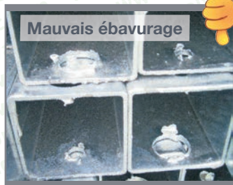
Photos 60 et 61 : Défauts d'ébavurage et de coulure
