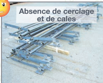
Photos 62 et 63 : Mauvais colisages
