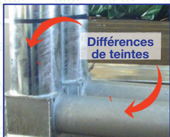
Photos 1 et 2 : Types d'aspects de surface dus à la réactivité des aciers
