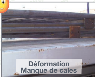
Photos 64 et 65 : Les conséquences d'un mauvais colisage
