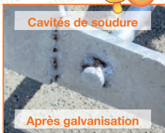
Photos 48 et 49 : Les défauts de soudures discontinues
