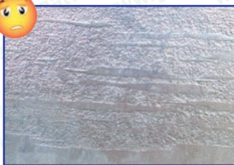
Photos 8 et 9 : Défauts dus au laminage
