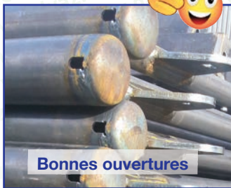
Photos 34 : Perçages en extrémité de tube fermé
