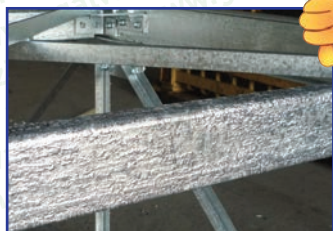
Photos 6 et 7 : Défauts de réactivité (fortes épaisseurs de zinc)
