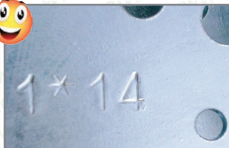
Photos 56 et 57 : La frappe à froid
