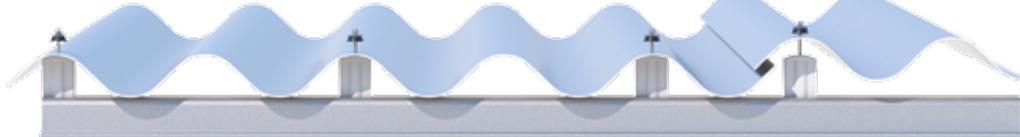
Les fixations sont placées sur les sommets des 1<sup>ère</sup>, 3<sup>ème</sup> et 5<sup>ème</sup> ondes.
