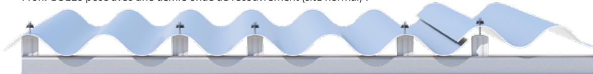
Les fixations sont placées sur les sommets des 1<sup>ère</sup>, 3<sup>ème</sup>, 4<sup>ème</sup> et 6<sup>ème</sup> ondes
