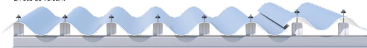
En bas de versant, les fixations doivent être posées sur chaque sommet d'onde, quelque soit le profil (GO110 - 177/51 avec 6.5 ondes ou GO92 - 177/51 avec 5.5 ondes).
