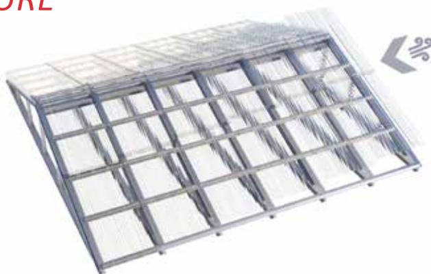
Les plaques doivent être installées de l'égout au faîtage, dans le sens inverse des vents de pluie dominants.
