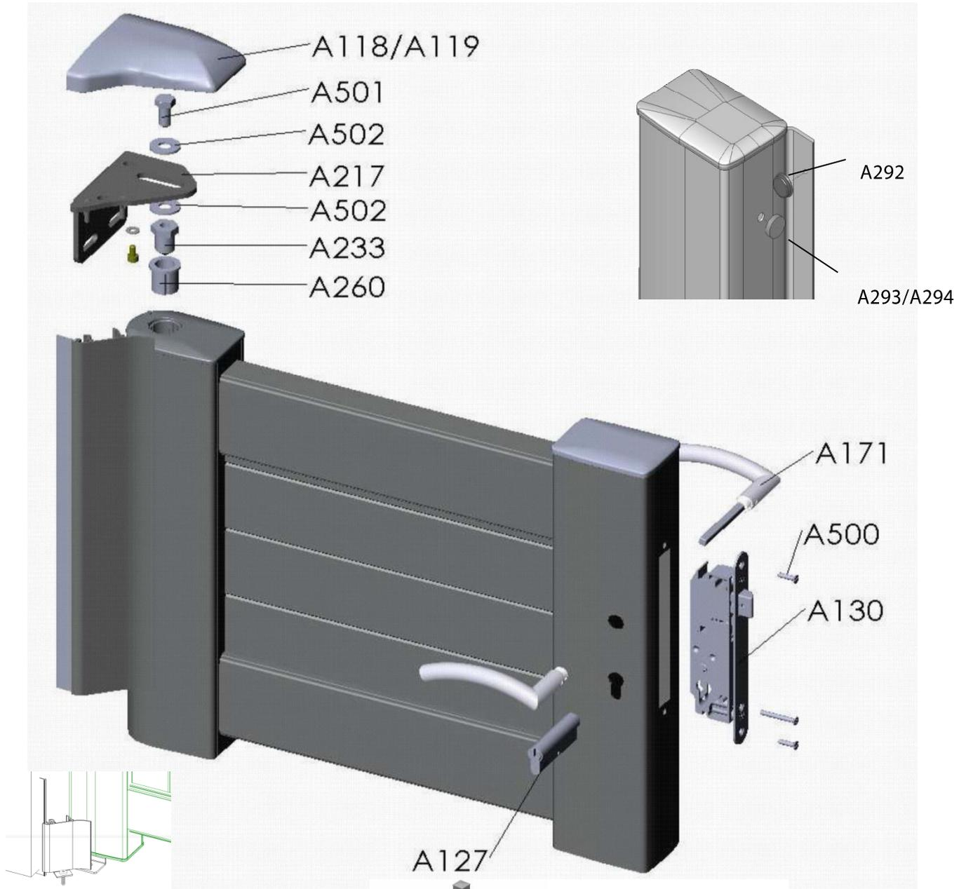
Crocheter le profil latéral dans la première goupille puis faire pivoter pour un centrage sur le deuxième goupille. Laisser un jeu entre le profil latéral et le montant inférieur ou égal à 8 mm. (Conforme à EN13241-1).
